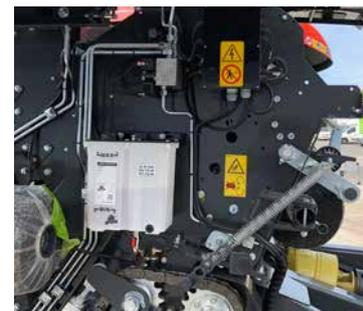
Stahlhydraulikleitungen für hohe Zuverlässigkeit
