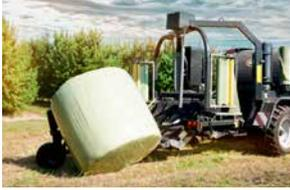
Der Ballenaufsteller wird zum Straßentransport auf die Maschine gezogen.
