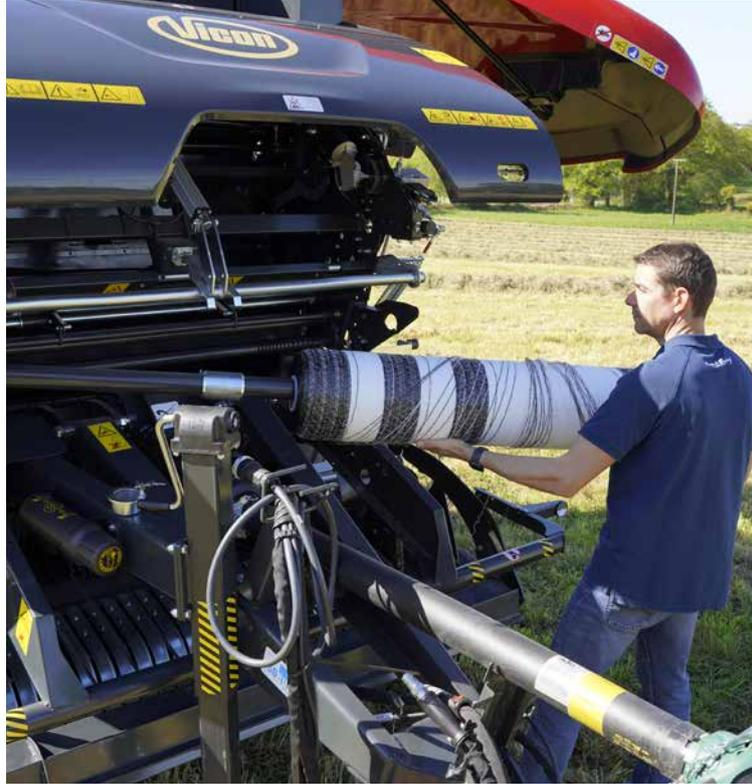
Die niedrige Ladehöhe und das leichte Einlegen der Netzrollen bedeuten minimale Standzeit zum Netzwechsel und mehr produktive Zeit zum Pressen.
