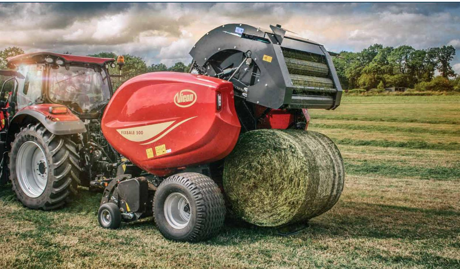
*Die Vicon FixBale 500 ist für den anspruchsvollen Einsatz geschaffen und somit die perfekte Wahl für Futterbaubetriebe und Lohnunternehmen. Die neue Ballenkammer mit 18 verstärkten und extra robusten Presswalzen wurde für extreme Einsatzbedingungen komplett neu entwickelt. Die neue innovative hydraulische Dichtesteuerung wurde speziell auf die hohe Durchsatzleistung und hohe Pressdichten abgestimmt, während der Leistungsbedarf für einen effizienten Einsatz auf ein Minimum reduziert wurde.*
