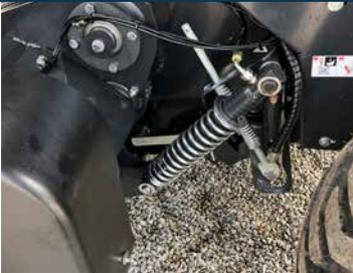
Die Pick-up-Entlastung gewährleistet eine perfekte Boden Anpassung.
