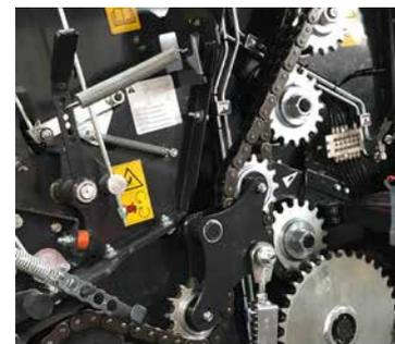
1¼"-Hochleistungsketten („HBC“) für alle Antriebe von Ballenkammer und Rotor
