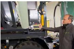
Für Wartungs- und Servicearbeiten können sämtliche Funktionen so direkt an der Maschine gesteuert werden.
