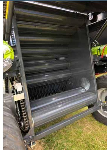
Presskammer mit zwei Bodenwalzen
