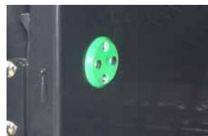
Feuchtigkeitssensoren befinden sich innerhalb der Ballenkammer.
