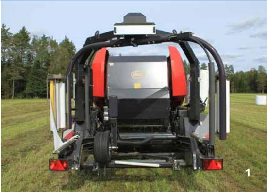
Sobald das Netz um den Ballen gewickelt wird, fährt der Wickeltisch unter die Heckklappe der Presse.
