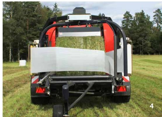
Der Doppel-Satellitenwickler wickelt die eingestellte Anzahl an Folienlagen um den Ballen.
