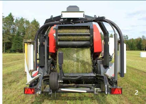
Der Ballen wird direkt auf den Wickeltisch abgelegt.
