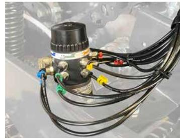
Automatische Kettenschmierung mit individuell einstellbaren Ausgängen
